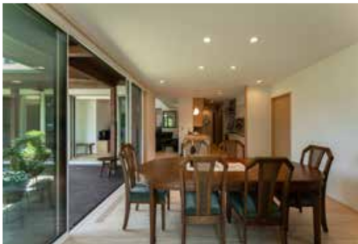
各室とも庭や借景が楽しめる大きな開口を設置。サッシは断熱性の高い「TW」(LIXIL)を採用
