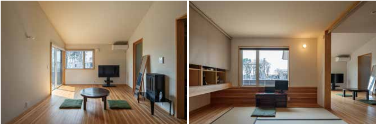
右／畳コーナー（和室）はリモートワークをする仕事場にも客間にもなる。自然光で明るさを確保 左／リビングのコーナーには東側にウッドデッキに出る掃き出し窓、南側に縦すべり出し＋FIX窓を設けた。トリプルガラス樹脂窓なので窓辺が寒い
